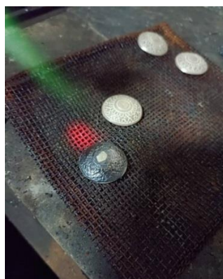
ภาพที่ 8 ใช้ไฟเพื่อให้ความร้อนจนยาถมละลายทั่วชิ้นงาน
