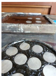
ภาพที่ 2 แผ่นโลหะเงินที่กดติดบนชั้น
