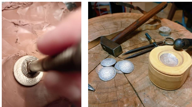
ภาพที่ 5 การโอบชิ้นงานให้มีความแว้ความมันตามต้องการ
