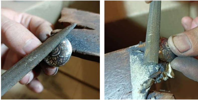
ภาพที่ 9 ยาจนถูกขัดออกด้วยตะไบ
